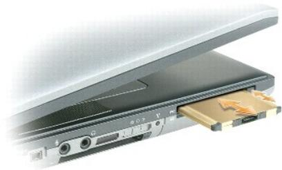
Компьютер распознает большинство плат и автоматически загружает необходимые драйверы. Если программа настройки выдаст запрос на загрузку драйверов производителя, используйте гибкий диск или компакт-диск, которые прилагаются к плате PC Card.
