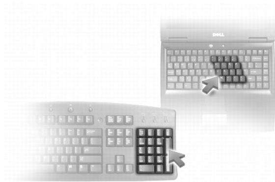
Встроенная цифровая клавиатура работает также как и внешняя цифровая клавиатура. Каждая клавиша выполняет несколько функций. Цифры и символы клавиатуры указаны синим цветом на правой части клавиш клавиатуры. Чтобы ввести цифру или символ, нажмите клавишу <Fn> и удерживая ее, нажмите нужную клавишу.
