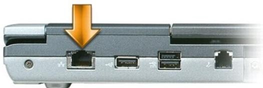
3. Подсоедините другой конец сетевого кабеля к устройству для сетевого соединения или к внешнему коммутационному сетевому разъему.
