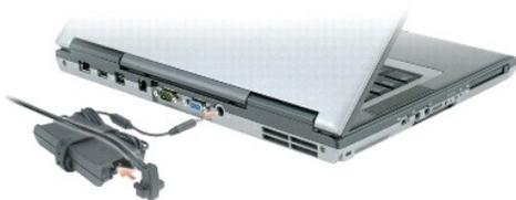
Адаптер преобразует напряжение переменного тока в напряжение постоянного тока, который используется для питания компьютера. Адаптер переменного тока можно подключать как к включенному, так и к выключенному компьютеру.
