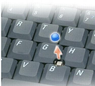
1. Снимите колпачок с микроджойстика.
